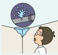
③ 給排水管の取付ミスにより、水が漏れ、壁が汚損した。
